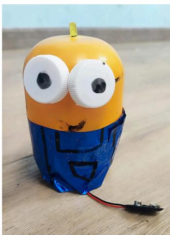
Prototipo di robot a forma di Minions, dovrebbe seguire una logica di funzionamento: se c'è luce il led resta spento, se c'è buio il led si accende. Questo dimostra che i bambini hanno iniziato a comprendere il concetto di istruzione condizionale e la relazione tra input (luce/buio) e output (led acceso/spento). È stato ideato e realizzato da bambini di 5/6 anni
